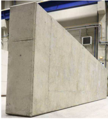
Figure 12. Face exposée au feu de la dalle avant et après l'essai de convenance
