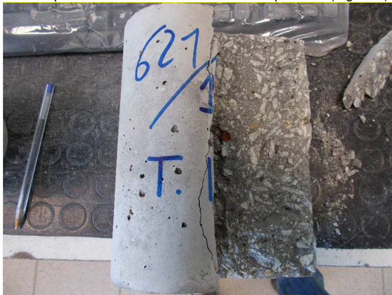
Figure 6. Essai de résistance à la traction indirecte, rupture sur mix design gneiss C30/37
