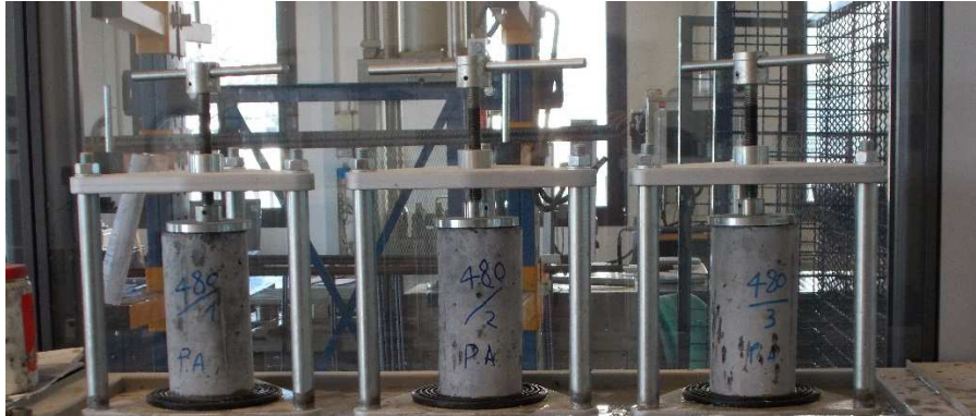
Figure 5. Essai de pénétration à l'eau pour mix design micaschistes C45/55 en cours.
