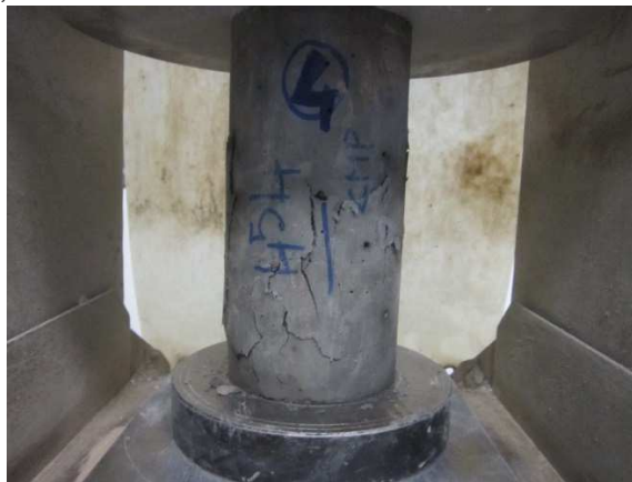
Figure 4. Essai de résistance à la compression sur mix design micaschistes C30/37, rupture.
