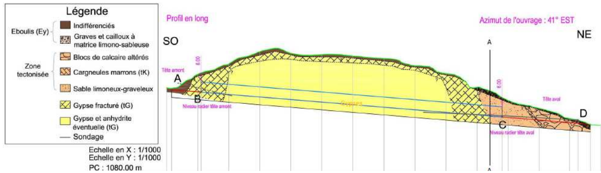
Figure 8. Galerie de la piste A43 – Coupe géologique interprétative
